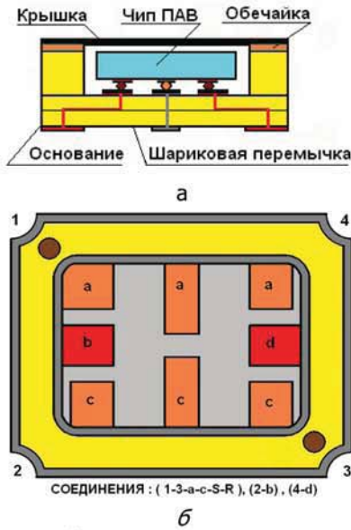
Рис. 4. Миниатюрный корпус типа CSSP 2,0x1,6x0,65 мм для монтажа пьезоэлементов LCRF по технологии "перевернутого" кристалла: а – разрез корпуса; б – контактные площадки на основании внутри корпуса
